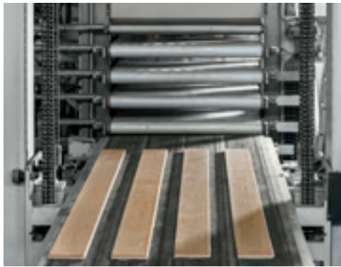
Verpressen der drei spannungsfreien Massivholzschichten.
