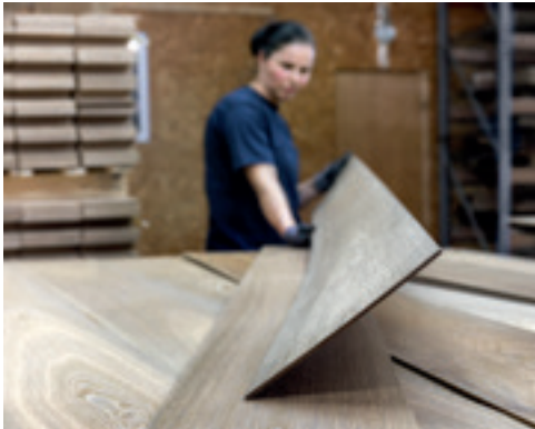
Endsortieren der Decklagen: Das menschliche Auge entscheidet.
