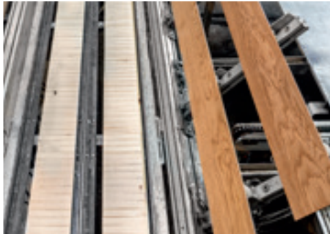
Zusammenfügen von Deck-, Mittel- und Rücklage des Naturholzbodens.
