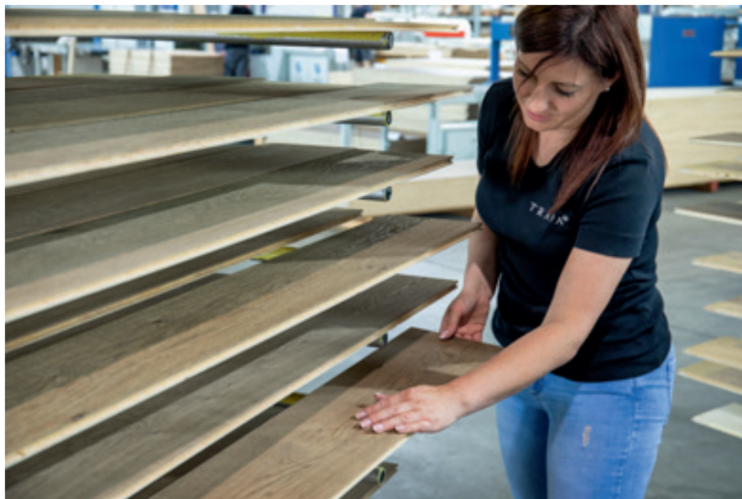
Nach der Laugenbehandlung muss jede einzelne Diele auf dem Hordenwagen lufttrocknen.
