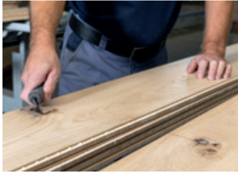
Auskratzen von Ästen und losen Fasern vor dem Kitten.
